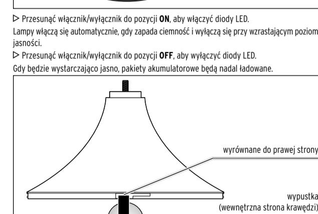
3. Umieścić korpus lampy wgłębeniem na wypustkę poewnętrznej stronie krawędzi pokrywy i przykręcić korpus lampy do pokrywy.
